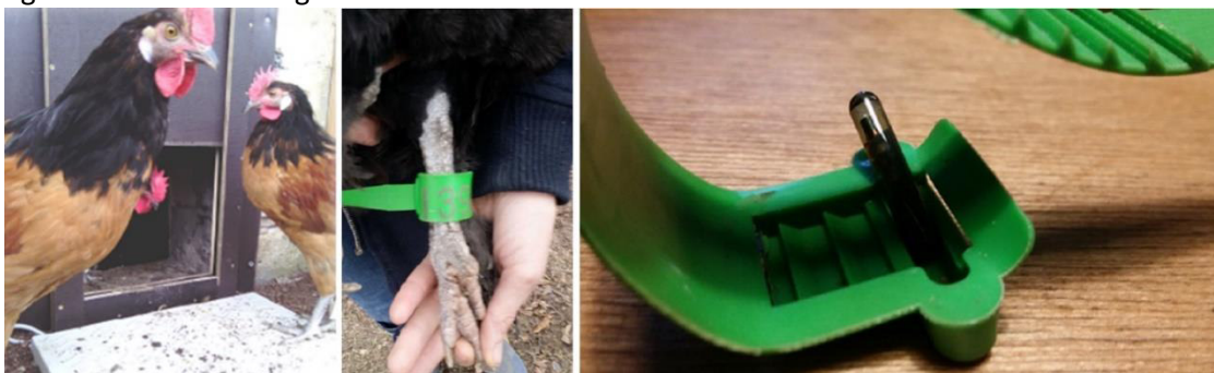
Abb. 19: Boden-Ringantenne (li.), nummeriertes Legband (zentr.), RFID Transponder(re.)
