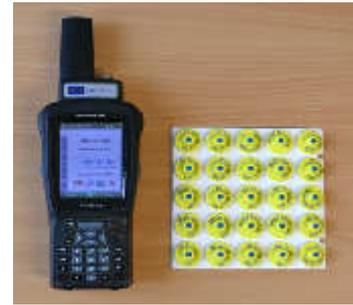
Abbildung 1: Tierindividuelle Kennzeichnung und Auslesen mittels Transponder-technik
