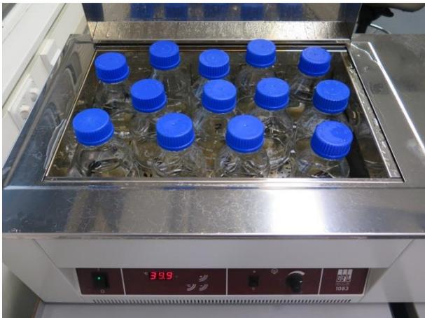
Abbildung 5: Wasserbad zur Überprüfung der Verdaulichkeit *In vitro*
