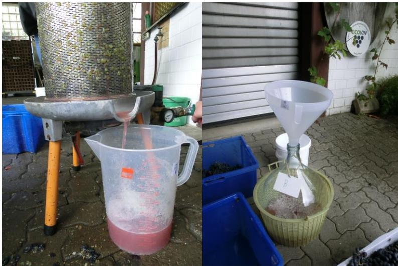
Abbildung 15: Im Versuch verwendete Hydropresse und Glasballon (25L).
