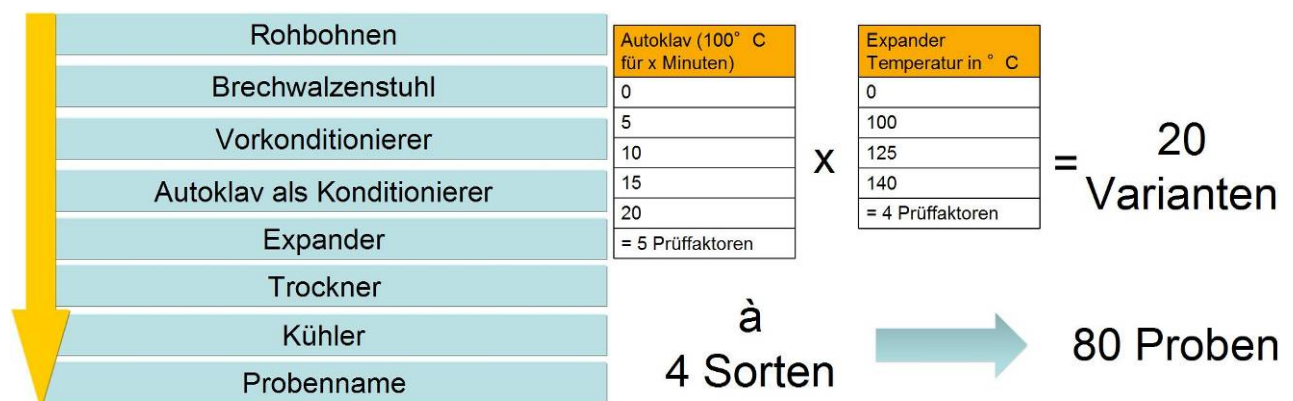
Abbildung 5: Versuchsablauf für eine Probenvariante in dem Versuchstechnikum bei Amandus Kahl.
